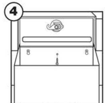
4 Secure mailbox to wall with screw. Buzón de seguridad a la pared con tornillos.
